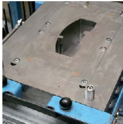
Molde profundo (para piezas de alta rotación).
